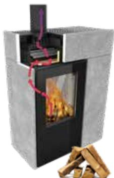
En mode bois, le clapet de cheminée est positionné de manière à favoriser la combustion par tirage naturel pour une excellente combustion et un aspect de flamme agréable.
