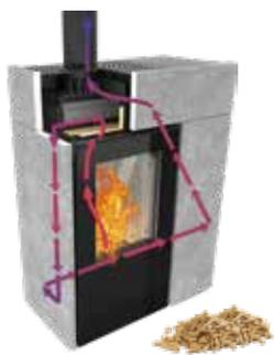
En mode granulés, la vanne de gaz de combustion dévie vers l'échangeur de granulés et l'extracteur de gaz de combustion pour une performance et une régulation parfaite de la combustion.
