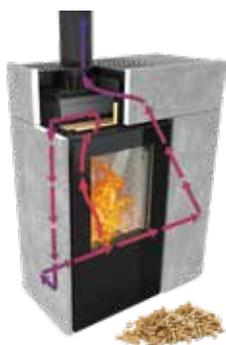
En mode pellet, la vanne de gaz de combustion dévie vers l'échangeur de granules et l'extracteur de gaz de combustion pour une performance et une régulation parfaite de la combustion.
