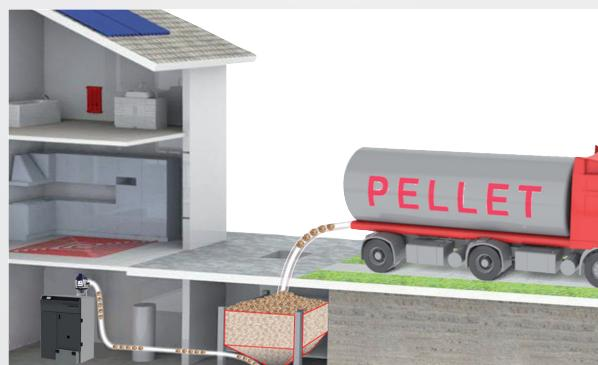
Silos stockage pellet de: / Remote stoffen silo:
