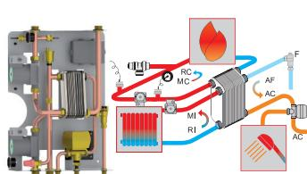
**\*Kit V** « à sac au dos » pour H2Oceano À VASE OUVERT doté d'écran déporté. Kit pour séparer l'installation primaire de celle secondaire avec thermo-cheminée associées à une chaudière à gaz avec production instantanée d'eau sanitaire; comprenant un circulateur pour le circuit secondaire. Composé de : échangeur à 3 voies, électrovanne à 3 voies, circulateurs, vanne de sécurité, fluxostat à effet Hall, carte électronique.
