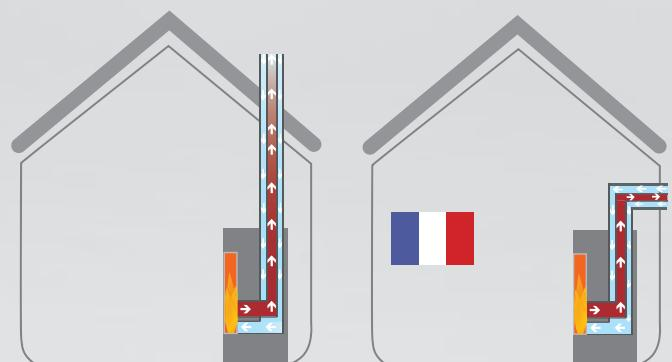
Exemple d'installation avec la sortie des fumées et la w d'air extérieure coaxiales.
