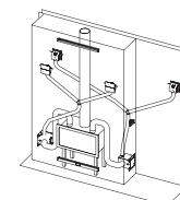
Kit rallonge 3 mètres tuyau isolé Ø 6,5 cm permet d' allonger la canalisation de 6 à 9 mètres
